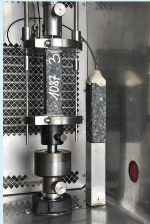
SIST EN 12697-46: Odpornost asfaltne plasti proti razpokam pri nizkih temperaturah z enoosnimi nateznimi preskusi Low temperature cracking and properties by uniaxial tension tests
