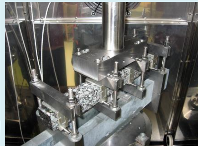
SIST EN 12697-22: Preskus nastajanja kolesnic (mala naprava, v zraku pri 60°C) Wheel tracking, small size device
